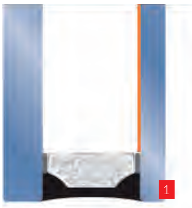
Basisprincipe van geluidsisolatie: afzonderlijke ruiten van verschillende dikte, eventueel met grotere spouw.
